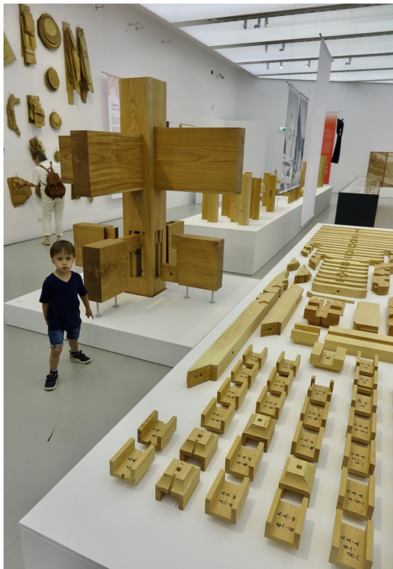
Elementy ciesielskiego łączenia belek
